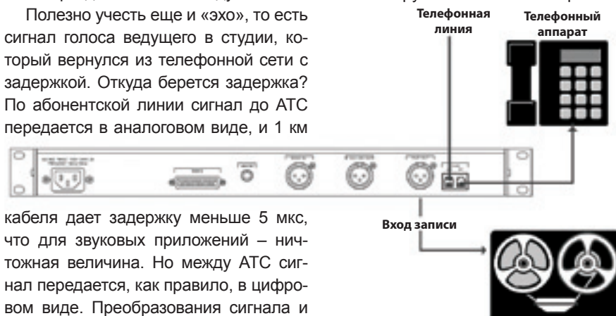
Запись интервью, поздравлений или заявок с помощью телефонного гибрида
